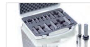
Os mandris de pré-montagem VOSS na versão básica para a montagem de anilhas possuem uma tolerância inferior que as conexões normais e são resistentes ao desgaste. Mas também é necessário controle: o cone interno dos mandris deve ser verificado, no mínimo, a cada 50 pré-montagens. Ideal para isso são os calibradores cônicos VOSS, individualmente ou como conjunto completo para todos os tamanhos..
