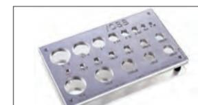
Que rosca tem o corpo da conexão? Roscas métricas ou em polegadas são, às vezes, difíceis de diferenciar. Com a placa de roscas VOSS, você consegue determinar rapidamente o tamanho da rosca, o tipo e se trata de uma rosca métrica ou em polegadas. Isso evita a incompatibilidade de roscas e previne vazamentos.
