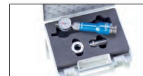
Os calibradores de verificação VOSS permitem uma inspeção de qualidade rápida durante o processo de pré-montagem em série ou na inspeção de recebimento de material. Basta colocar a extremidade do tubo (6-42 mm), apertar manualmente e ler os resultados. Após uma verificação visual adicional do material saliente na anilha e o controle está finalizado.
