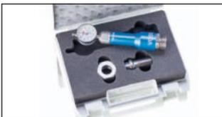
福士 (VOSS) 检验量规可以快速检验批量卡套预装的质量，并可用于进货检验。只需简单连接到管端 (6 - 42 mm)，用手拧紧，读取压力值，再目测卡套处的材料凸起，即完成检验。
