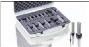
与普通螺纹管接头相比，用于卡套预装配的福士 (VOSS) 基本型预装配工具拥有很好的耐磨性，公差控制在很小的范围内，每大约预装 50 个卡套后，应当用量规检查装配情况是否符合标准。福士 (VOSS) 可以单独或整套提供所有规格的锥形量规。
