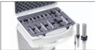
I raccordi per premontaggio VOSS nell'esecuzione base per il montaggio di anelli taglienti sono calibrati con precisione come nei normali raccordi filettati e sono resistenti all'usura. Ma anche in questo caso è necessario il controllo: la conicità del cono interno del raccordo filettato deve venire controllata almeno ogni 50 premontaggi. Ideali a questo scopo sono i tamponi VOSS, disponibili singolarmente o come set completo per tutte le dimensioni.
