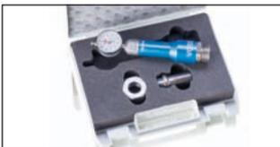
Con il Misuratore di profilo con manometro VOSS viene accelerato il controllo di qualità nei premontaggi di anelli taglienti nella produzione in serie e nell'accettazione merci. Attaccare semplicemente l'estremità del tubo (6-42 mm), serrare a mano, leggere il risultato. Dopo il controllo visivo supplementare dell'accumulo di materiale sull'anello tagliente il controllo è concluso.
