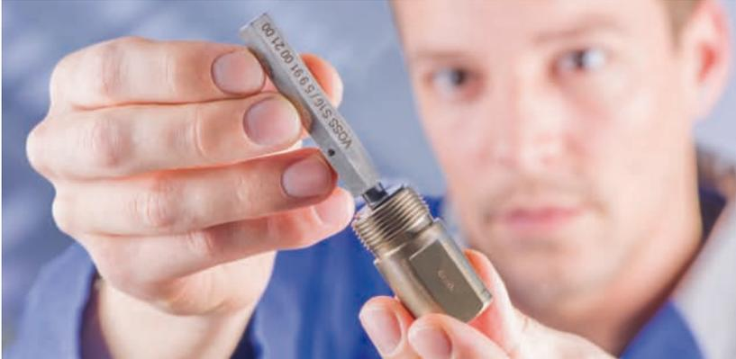
Controllo preciso della conicità: Tamponi.
