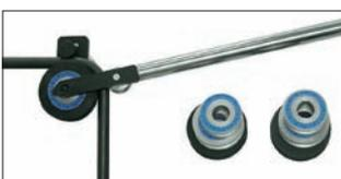
Ligero equipo de flexión manual para fijar a un tornillo de banco, para curvar con precisión tubos de 8 a 22 mm.
