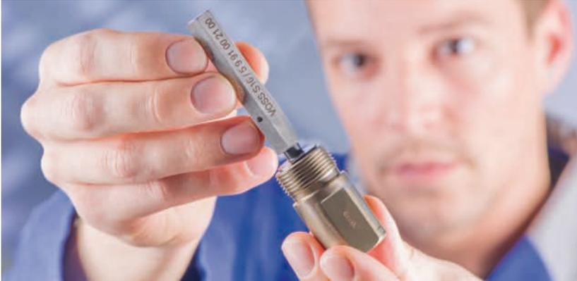
Control preciso del calibrado: calibres de conicidad.
