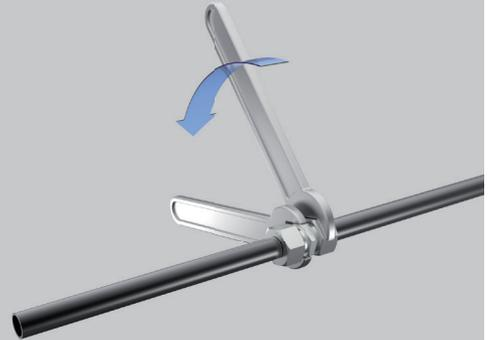
管外径 $\leq 18\text{mm}$ ，拧 1 1/2圈
