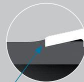
材料凸缘大约80%(使用不锈钢管：材料凸缘必须明显可见)
