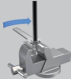
管外径 $\leq 18\text{mm}$ ，拧 1 1/2圈
