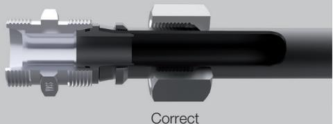
**4.3** Serrez l'écrou-raccord BV-10 à la main jusqu'au blocage.
