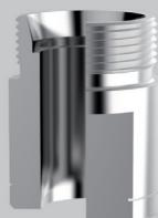
**4.1** 将管端插入 $24^\circ$ 锥中，并压至止挡。在装配过程中，管材必须顶住止挡，以免错误装配。
