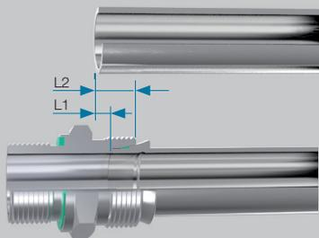
Altezza del raccordo VOSSForm<sup>SQR</sup>VA montato.
