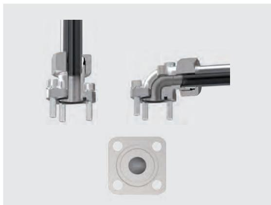
As conexões de flange com ligação quadrada sobressaem especialmente através das medidas reduzidas exteriores. São entregues nas versões reta e em ângulo. O portfólio engloba as medidas do diâmetro externo do tubo de 10 mm até 35 mm. A vedação do flange é feita através de uma vedação elástica (O-ring), a ligação da montagem através de parafusos cilíndricos. As ligações de flange foram concebidas para os padrões de orifícios de conexão dos fabricantes de bombas.
