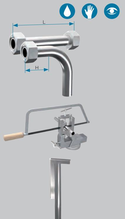
**2.2** Serrar o tubo em ângulo reto. É permitida uma tolerância de ângulo de  $\pm 1^\circ$ . Não utilizar cortadores de tubos ou lâminas abrasivas.
