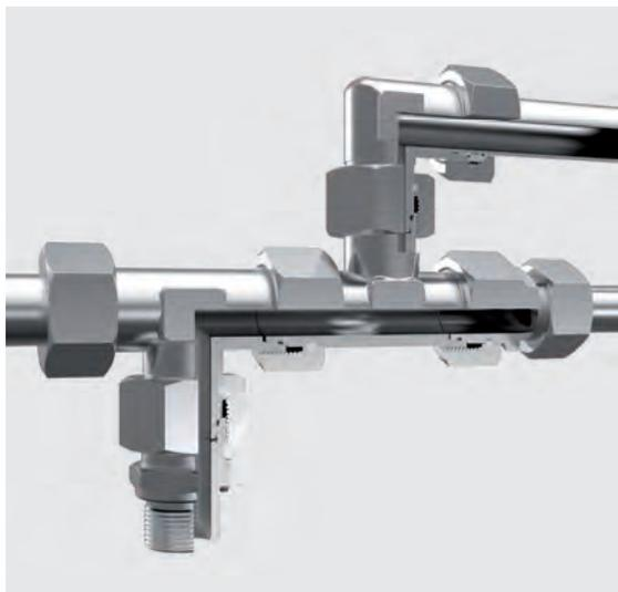
A conexão com vedação no cone 24° é um desenvolvimento lógico para a conexão ajustável com conector do flange e anilha pré-montada. Através do cone vedante aplicado no corpo da conexão, se consegue uma conexão estável especialmente segura e durável.
