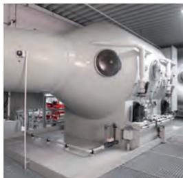
O ar de exaustão é aspirado diretamente sobre o tanque com unidades de lavagem de ar. A energia de aquecimento existente é recuperada.
