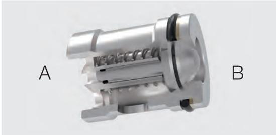
Como elemento de inserção para aparelhos hidráulicos com construção em placa ou para construção direta no aparelho e na carcaça da máquina, os cartuchos de inserção das válvulas de retenção VOSS permitem o fluxo numa direção e bloqueiam o mesmo no sentido contrário.
